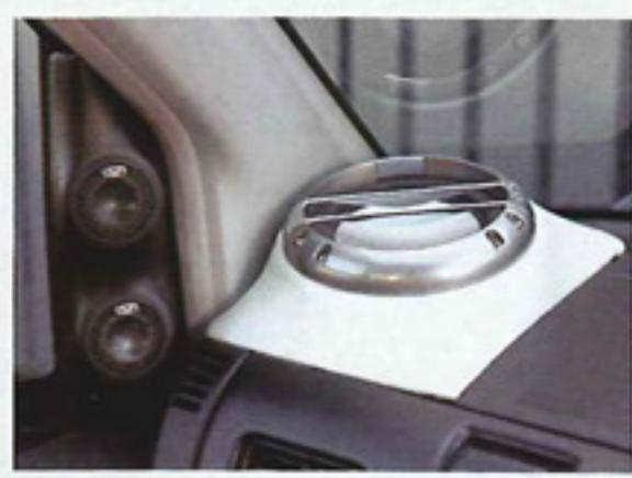
ドア×2発、ダッシュ×1発のトリプルミッドベースを採用しているため、ミッドベースとの音のつながりを考えると、ドアミラー裏が最適と判断。また、高域のスピード感やレスポンスを上げるためにダブルツイーターを採用している。さらに、ファイバーを駆使しつつ純正パネルを生かし、ドアミラー裏への取り付けを実現しているのだ。スピーカーへのインストールと比べ、リスナーに近くなりすぎるが、そこはタイムアライメントなどを使い、しっかり調整済みだ!!
