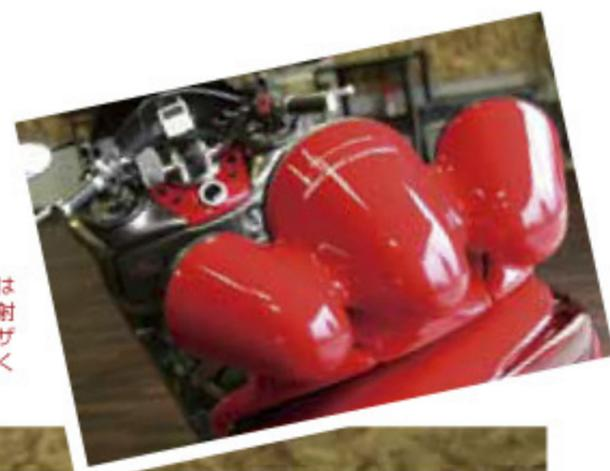
ウーハーボックスの形はボディ内部で低音を反射させる用途もある。デザインのためだけではなく考えられた形状なのだ
