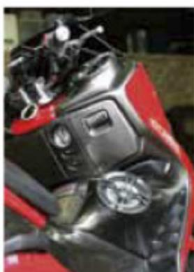
サブバッテリーも搭載して、大迫力のサウンドを出せるようになった。ハンドルの下のボルトメーターもワンオフ装着した
