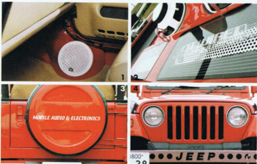
1/フロントのキッカー防水スピーカーはボートやヨットでの使用を考えたもの。MDF (中質繊維板)を防水処理したマウントに取り付けられる。2/リアに搭載するスピーカー、サブウーハーもフロント同様にキッカーのマリンシリーズ。アンプが収まるラックにはアクリル製の窓をインセット。FRPのカウルとの隙間はなく、防水は完璧。3/スペアタイヤカバーもレッドで統一。白文字は製作ショップ、ホットワイヤードのコンセプトワード。4/タイガーオートのステンレスバンパーでドレスアップ効果を発揮。
