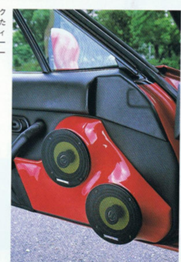
FRP製スピーカーボックス。ワンオフで製作されたボックス類はすべてボディと同色に塗られ、イエローをポイントにコーディネートされている。
