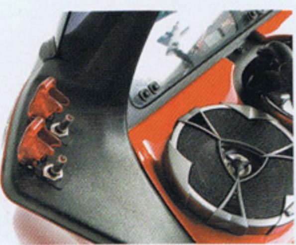
インパネの左前方には今最もアツいバーツのひとつであるミサイルスイッチが丁寧な作り込みによって施されている。向かって右側上がストロボ、左がヘッドライトとなっている
