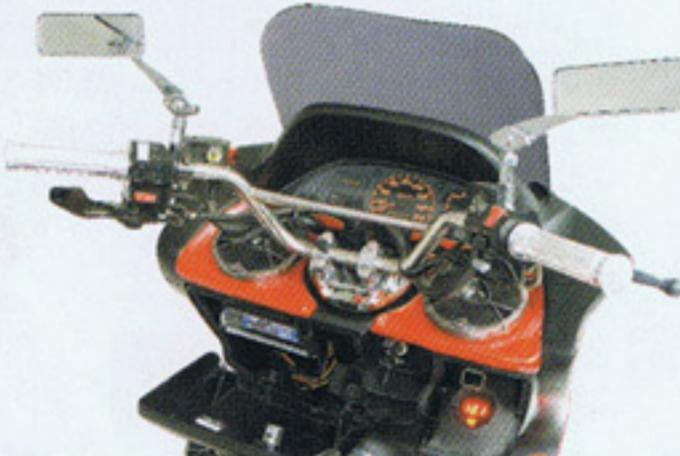
アルミグリップにバーハンドル化、ワンオフライザーによって高められたマットな質感のミラー。バッフルボードによる4インチスピーカー、ダッシュボード右のミニスペースにはデジタル計があり、インパネ周りはコックピット感覚にあふれている
