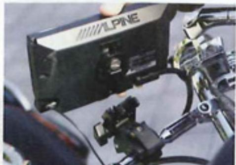
モニターの取り付けに専用のベースを使うことで、脱着を容易にしている。長時間離れる際には、外してトランクに収納するなど、防犯性も考慮されているのだ
