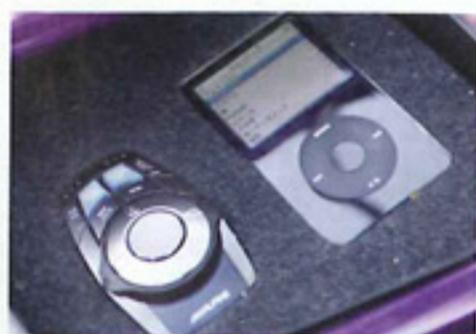
コントロール用のリモコンとソースであるiPodはコンソールボックスに収納される。もちろんただはまっているだけでなく、この裏には配線がなされ、Vハブへとつながっている
