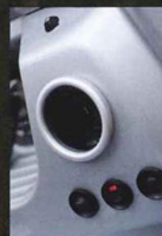
電気系のユニットが増えることによって、ボルトメーターだけでなく、アクセサリーとしてアームをビルトイン。機能性を演出
