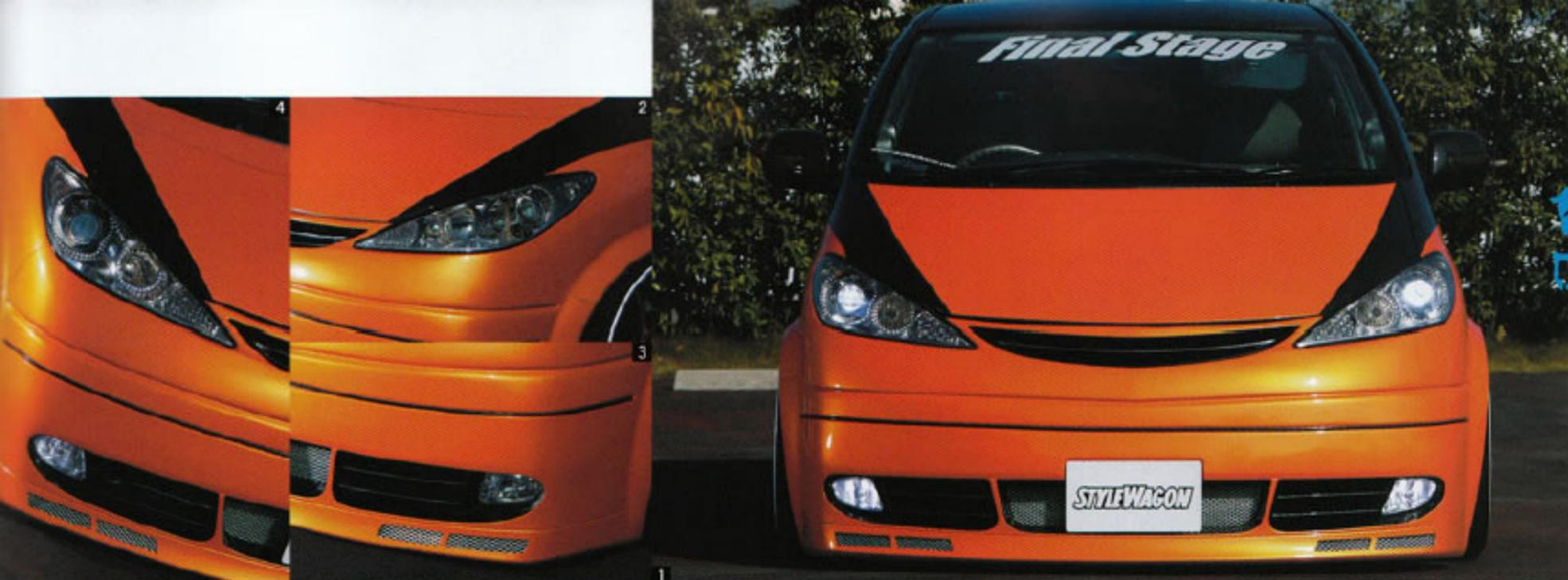
1.フル一体式デザインを採用するケイブレイクのフロント。そのグリルラインに沿って、ボンネットにプレスラインとガンメタラインを追加している。2.後期純正を移植したヘッドライトにはV35スカイラインの純正プロジェクターレンズが埋め込まれる。3.ケイブレイクとモードバルファムの16アリスト用をニコイチしたフロント。モードバルファムのエアロデザインを強調するため、フォグまわりをガンメタで塗り分ける。4.ヘッド&フォグともにライトはHID仕様。
